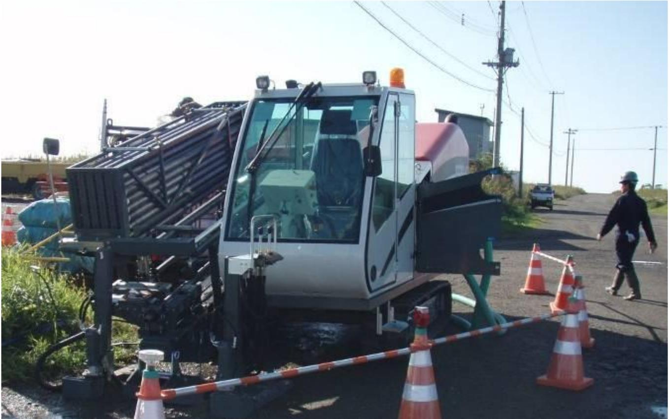
L'Entreprise de Génie Civil Iwashita Sangyo de Hachiken Nishi-Ku, Japon, a posé un fourreau PEHD de 560 mm avec sa machine de forage horizontal dirigé TERRA-JET 8522 S. La longueur du tir était de 60 m, et le sous-sol composé d'argile était facilement forable.
