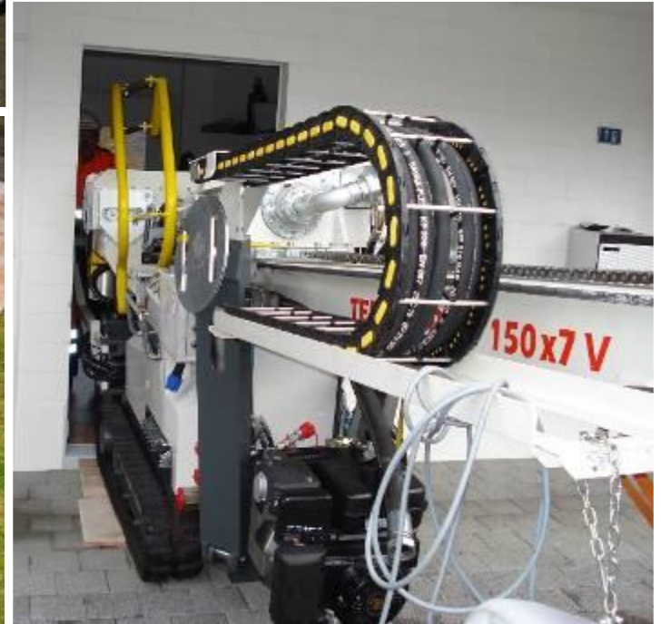
La TERRA-DRILL 150x7 ne mesure que 95 cm de large en position transport et peut donc ainsi passer par des portes de 1,00 m de large.
