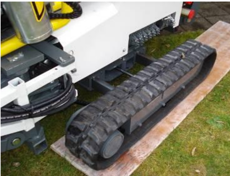
La voie du châssis à chenilles caoutchouc peut être réglée hydrauliquement.
