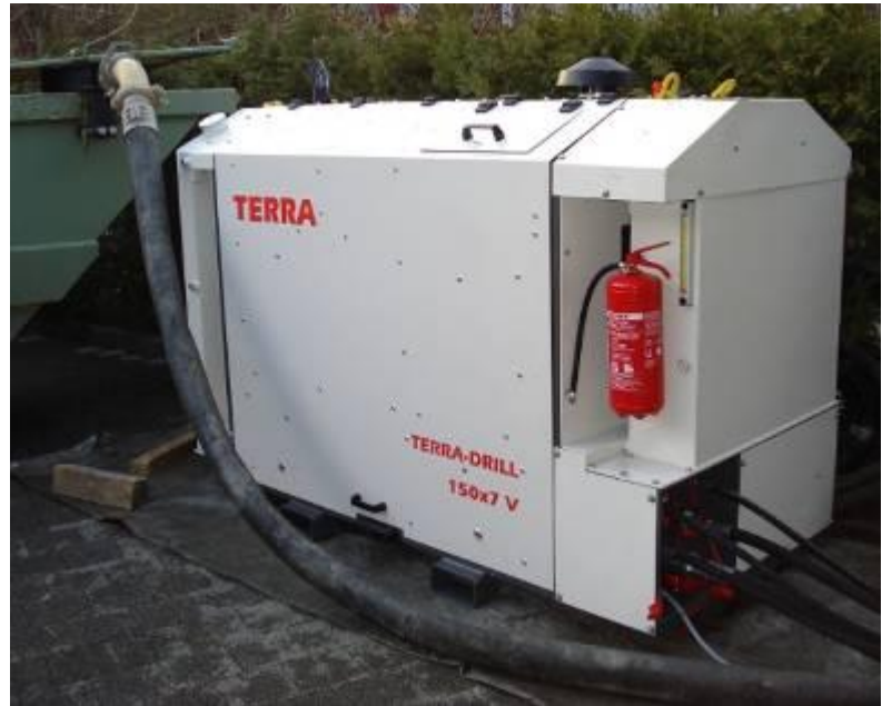
Le groupe d'entraînement hydraulique qui fait fonctionner la foreuse.
