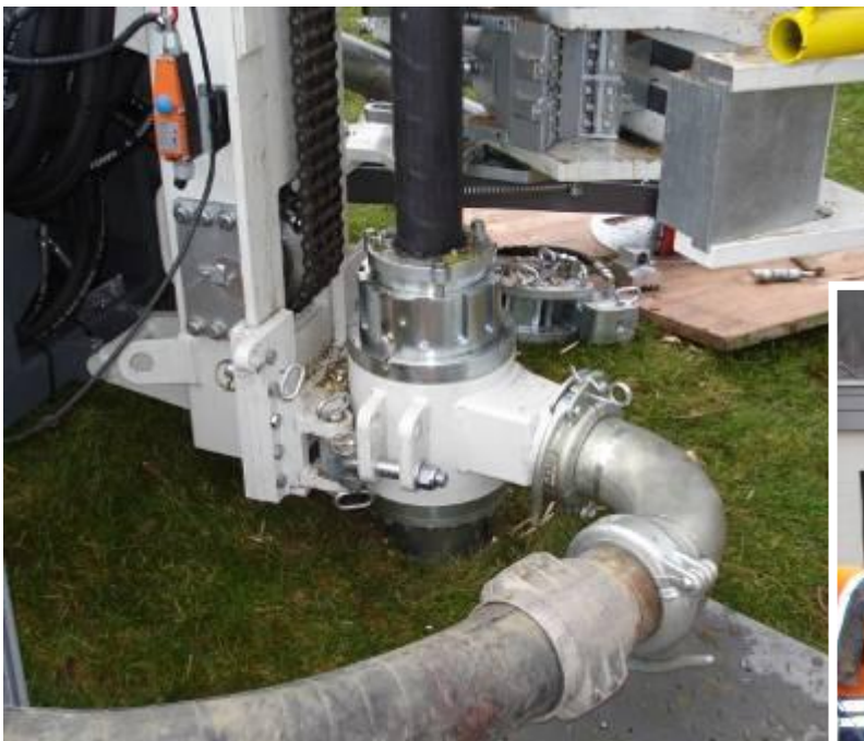
La foreuse se manipule avec la télécommande, ce qui permet à l'opérateur d'avoir une position optimale et une vue dégagée.
