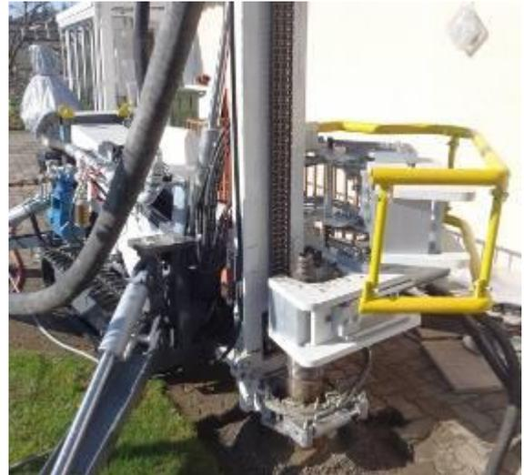
Le dispositif de serrage et de débloqué triple.
