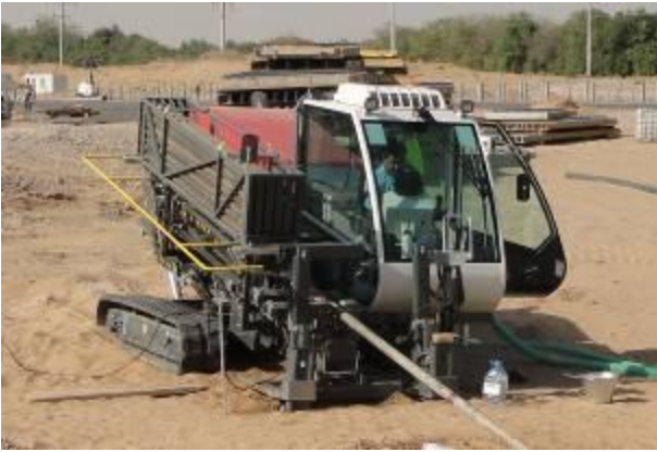
La TERRA-JET 8522 S au cours d'un forage. La cabine de conduite confortable est refroidie par une climatisation puissante (Puissance frigorifique supérieure à 6 kW).
