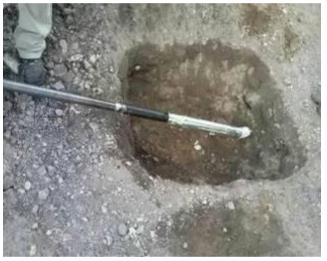
Pour ces terrains durs - remblayés et de graviers - on a utilisé une tête 3 doigts, qui surmonte sans efforts ce type de terrains.
