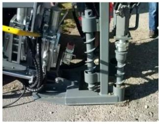
L'ancrage se fait hydrauliquement avec des tirants d'ancrage qui peuvent même percer l'asphalte. De ce fait, la TERRA-JET 1804 S est toujours ancrée de façon optimale
