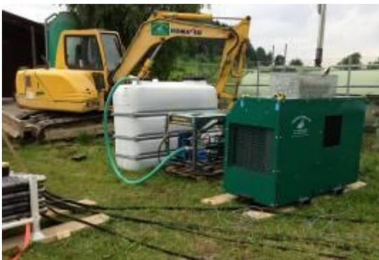
Le groupe hydraulique, la station de pompage et de mélange et la cuve sont installés séparément. Le groupe hydraulique est entraîné par un moteur diesel PERKINS, équipé d'un filtre à particules diesel qui répond aux normes suisses strictes en matière de gaz d'échappement.
