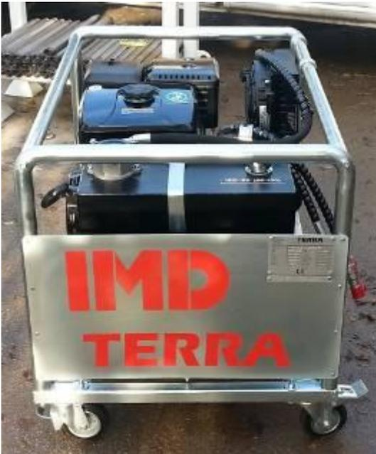
Le groupe hydraulique et les tiges de fonçage sont positionnés. Le groupe a un démarreur électrique, et un réfrigérant d'huile en option.
