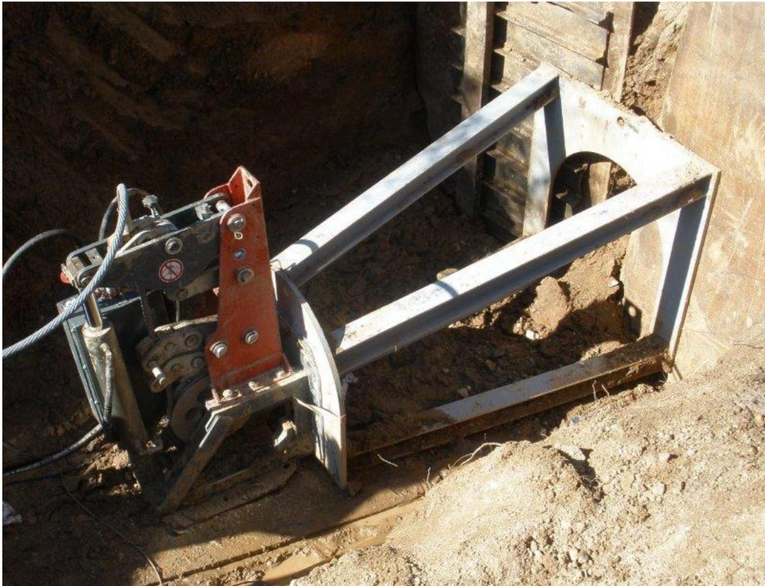
L'éclateur à câble X 400 avec le cadre avant spécial pour tuyau 500 mm
