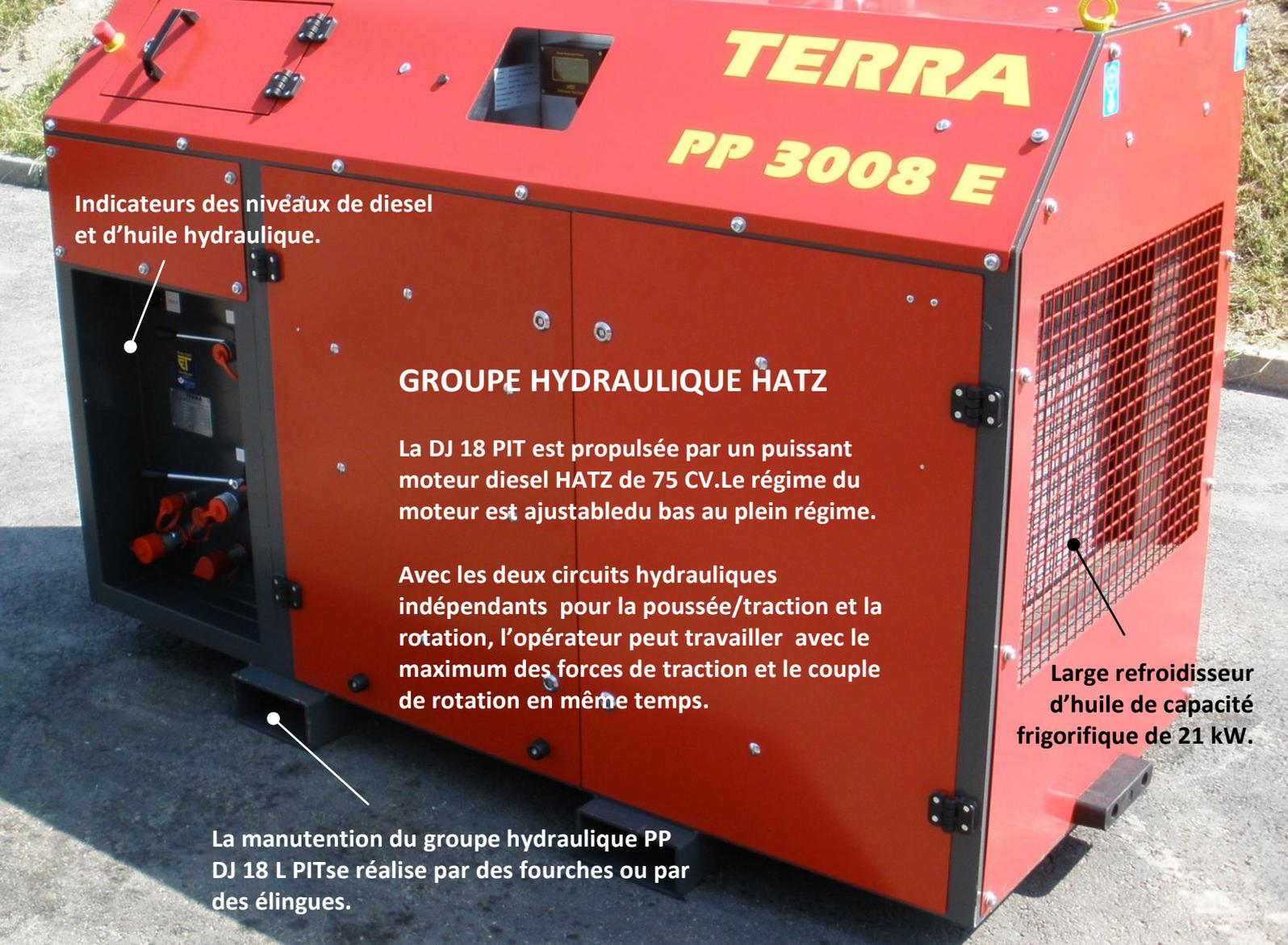
Indicateurs des niveaux de diesel et d'huile hydraulique.
