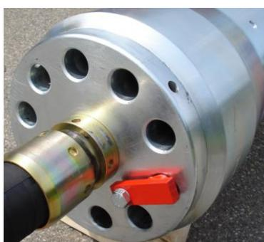
La barre de sécurité de transport rouge maintient le piston bloqué en position avant. Il ne peut pas bouger d'avant en arrière pendant le transport.
