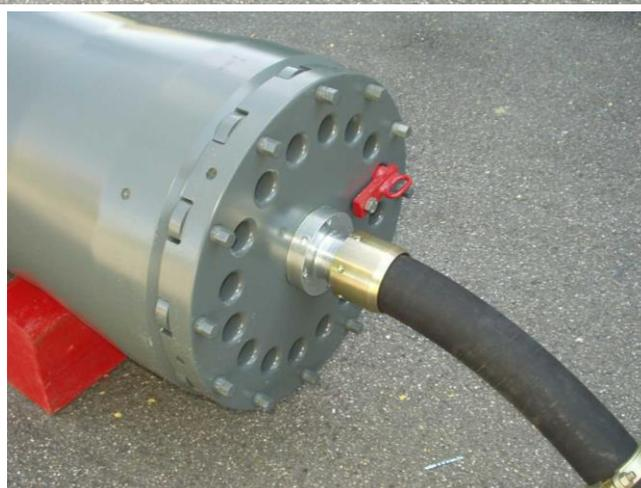
Le culot arrière peut être démonté sur le chantier, car il n'est pas collé. Il est bloqué par des plaques d'arrêt et des boulons spéciaux.
