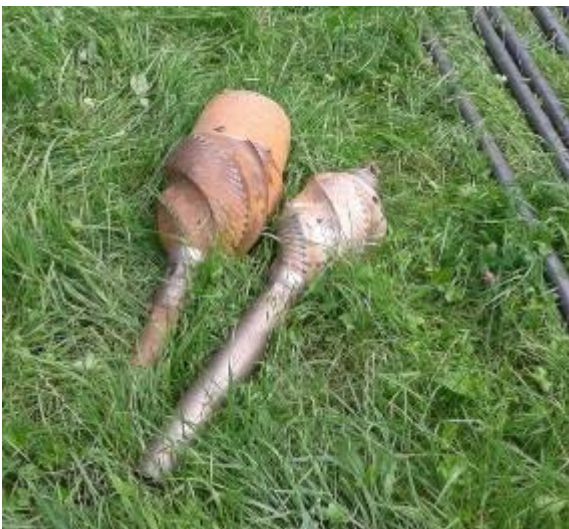
Le trou pilote long de 49 m a été élargi avec ces deux aléseurs au \varnothing 215 mm en intermédiaire, puis jusqu'au \varnothing 360 mm.
