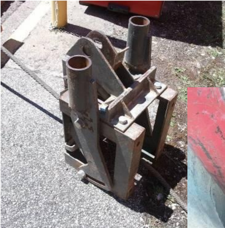
Ce châssis de regard passe au travers de la bouche \varnothing 620 mm et peut être posé au fond de regards de \varnothing 800 mm et 1'000 mm.
