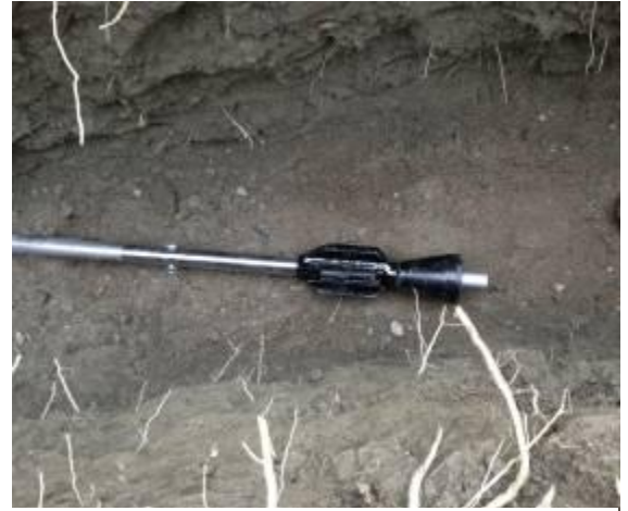
L'élargissement intermédiaire au diamètre 90 mm se fait avec une étoile cisailante et un cône élargisseur.
