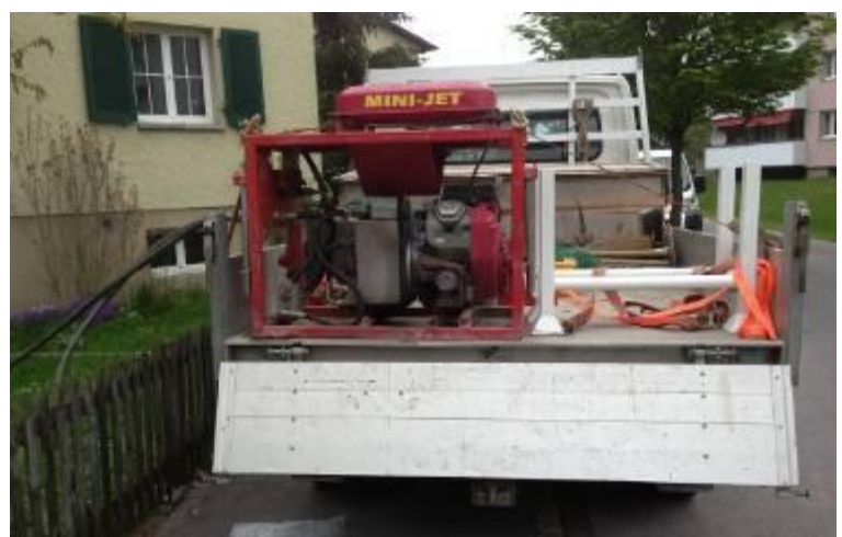
Le TERRA JACK 125 est entraîné par un groupe hydraulique.
